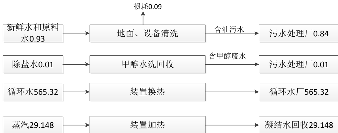
图 5.2-3 本项目水平衡图
